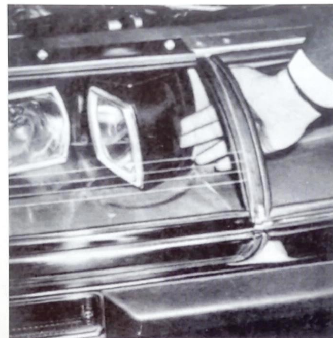
Fig. 33 - Pivotement à la main du phare directionnel
